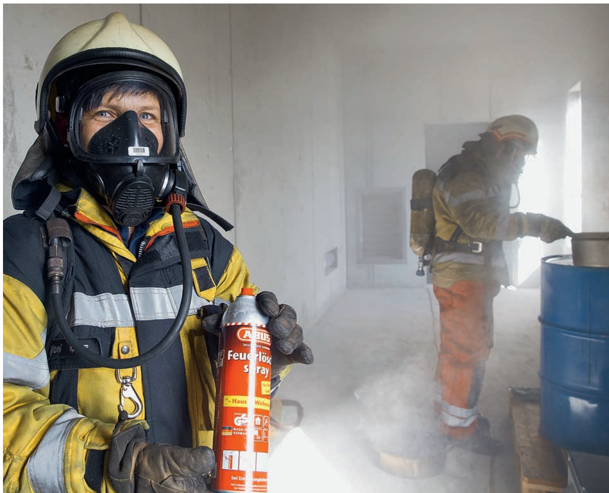
Löschspray: Testsieger Abus löschte den Ölbrand innert weniger Sekunden
