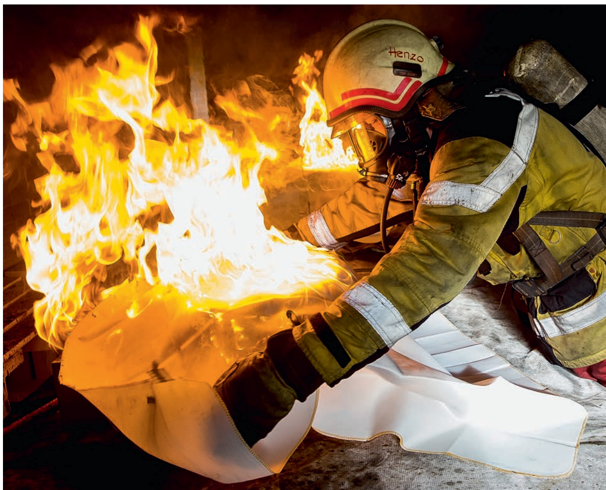
Löschdecke: Beim Löschversuch schlägt das Feuer durch die Decke
